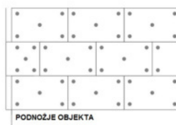
5 pričvrsnica/ploča ili 8 kom/m 2 fasade
