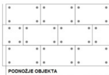
4 pričvrsnice/ploča ili 6 kom/m 2 fasade
